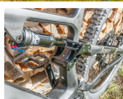
Cilo mise sur des composants de qualité, telle cette suspension Fox, à bras oscillant.
