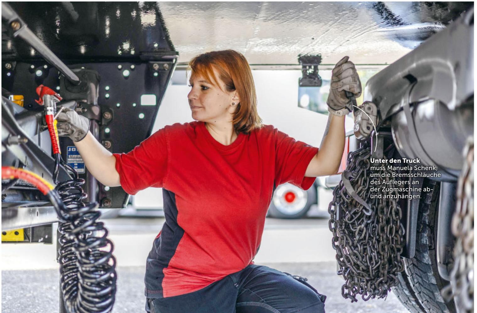
**Unter den Truck** muss Manuela Schenk, um die Bremsschläuche des Auflegers an der Zugmaschine ab- und anzuhängen.
