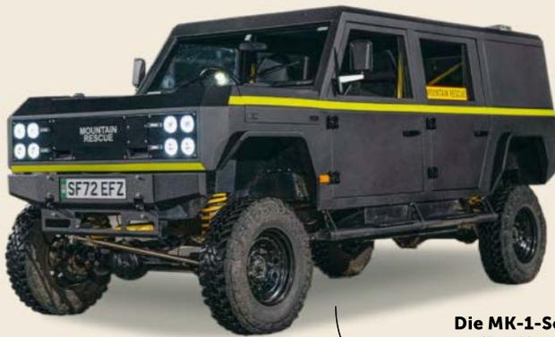
Die MK-1-Sonderversion verfügt über einen 82-Kilowattstunden-Akku. Eine Ladung reicht für gut 300 Kilometer oder sechzehn Stunden Einsatz.
