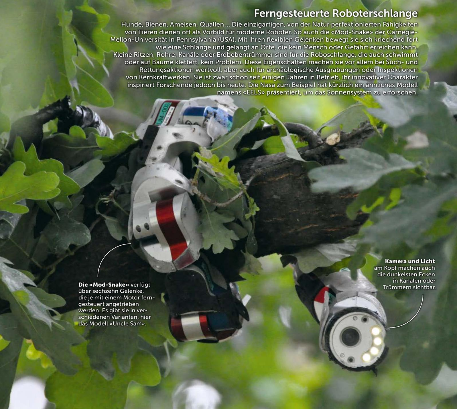
Die «Mod-Snake» verfügt über sechzehn Gelenke, die je mit einem Motor ferngesteuert angetrieben werden. Es gibt sie in verschiedenen Varianten, hier das Modell «Uncle Sam».
