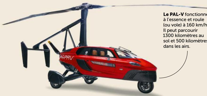
Le PAL-V fonctionne à l'essence et roule (ou vole) à 160 km/h. Il peut parcourir 1300 kilomètres au sol et 500 kilomètres dans les airs.
