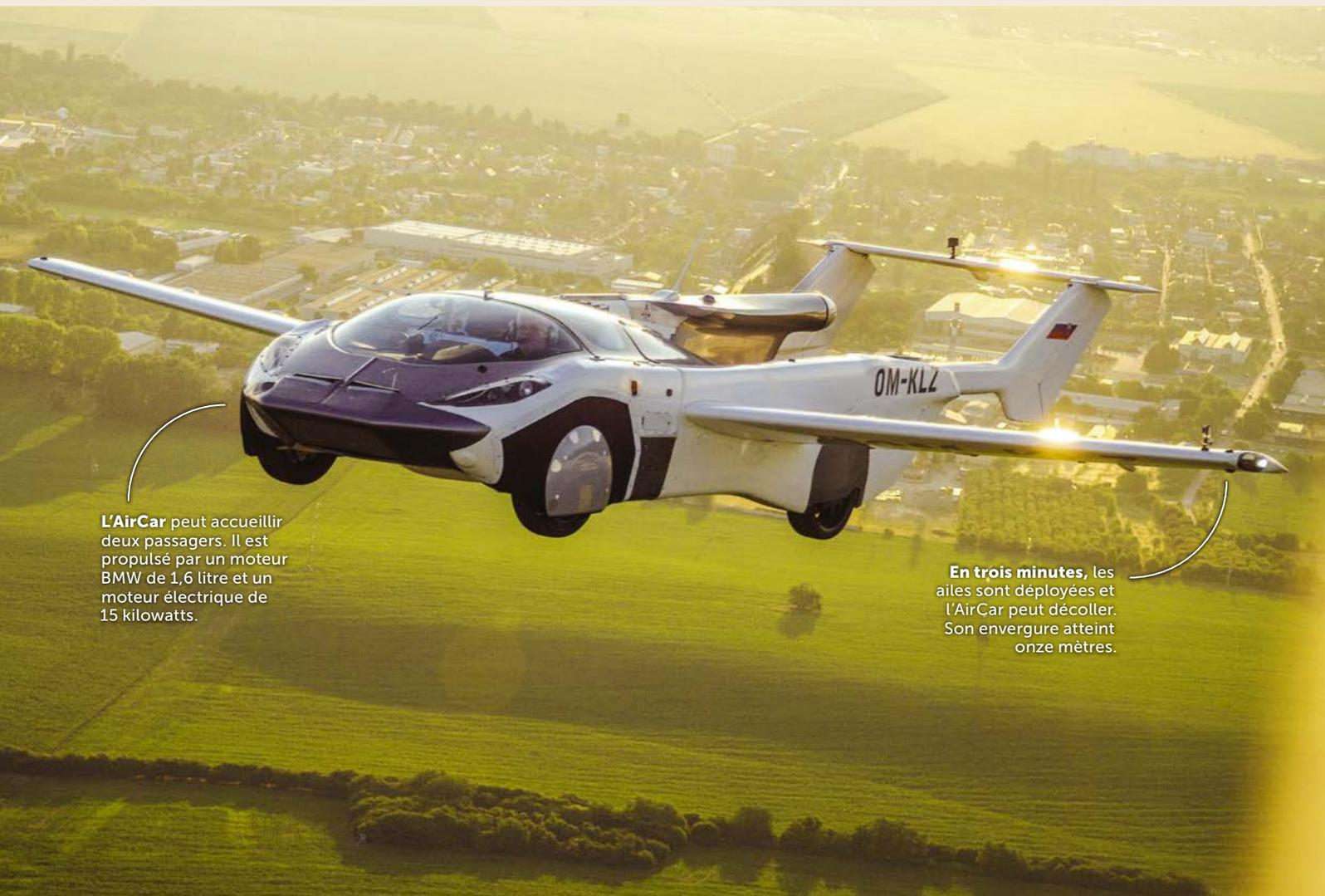
L'AirCar peut accueillir deux passagers. Il est propulsé par un moteur BMW de 1,6 litre et un moteur électrique de 15 kilowatts.
