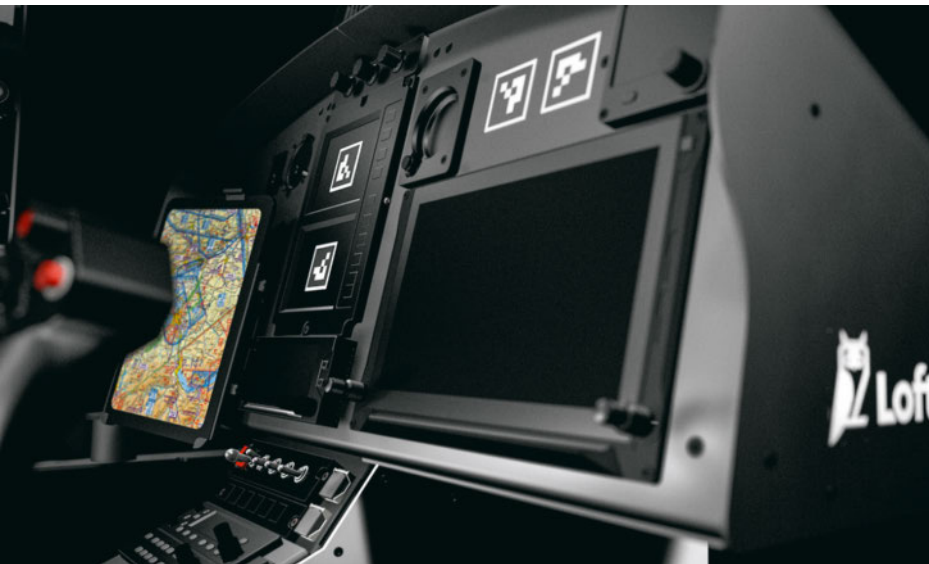
Dans le cockpit Full Replica (ici d'un H125), tous les instruments peuvent être commandés manuellement.
