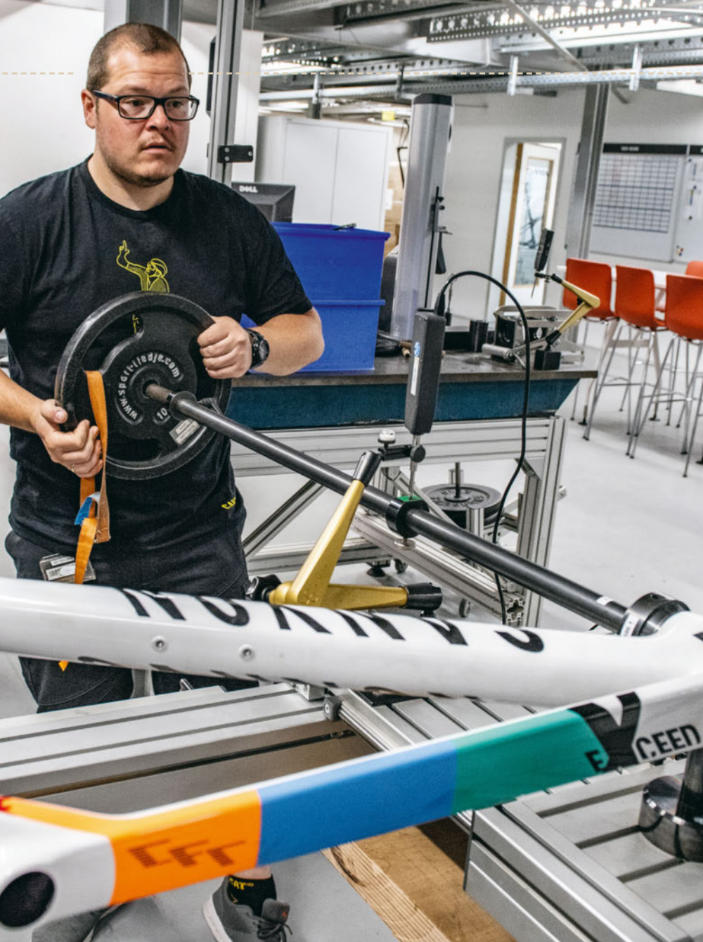
Dans le laboratoire de test, Dennis Halter, ingénieur matériaux, vérifie la stabilité d'un prototype de cadre.
