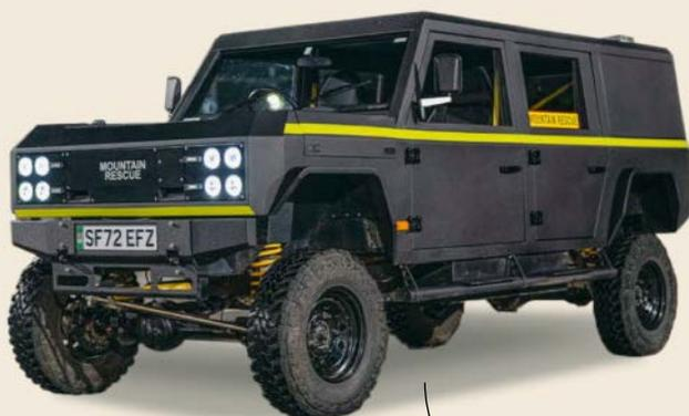
Le MK-1 est doté d'une batterie de 82 kWh. Une charge est suffisante pour 300 kilomètres ou 16 heures d'intervention.
