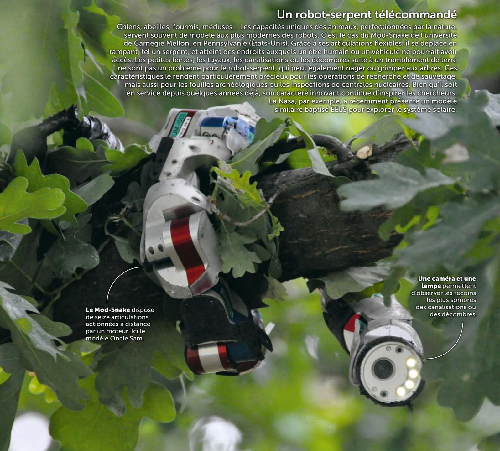
**Le Mod-Snake** dispose de seize articulations, actionnées à distance par un moteur. Ici le modèle Oncle Sam.
