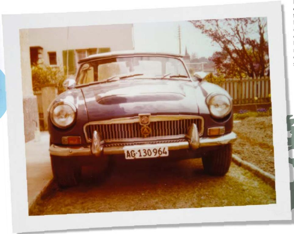
**Le renflement du capot:** la marque de fabrique de la MGC. La consommation du moteur six cylindres de trois litres était néanmoins tolérable, en fonction du style de conduite.
