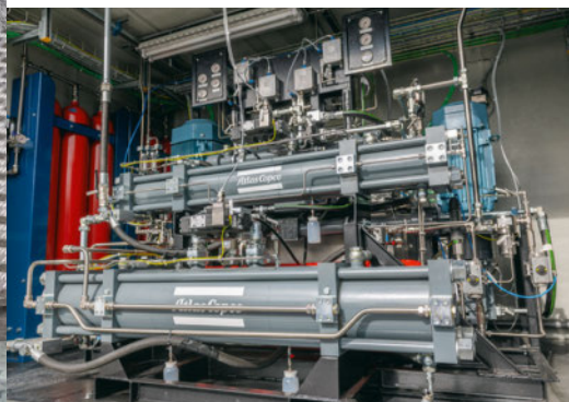
L'hydrogène subit une compression , passant de 30 à 500 bars.
