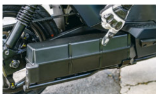
La batterie est placée des deux côtés du bras oscillant.
