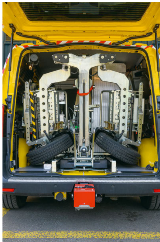
Eine integrierte Achse zum Transport von Autos befindet sich neuerdings im Heck einiger Einsatzfahrzeuge.
