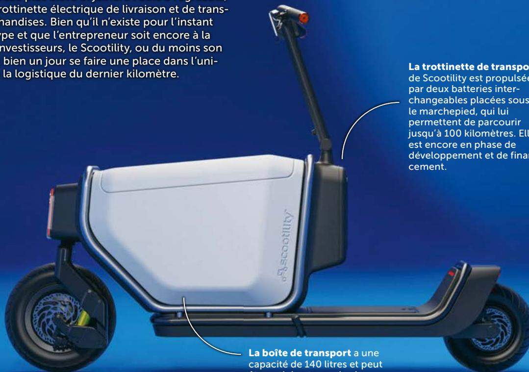
**La trottinette de transport** de Scootility est propulsée par deux batteries interchangeables placées sous le marchepied, qui lui permettent de parcourir jusqu'à 100 kilomètres. Elle est encore en phase de développement et de financement.
