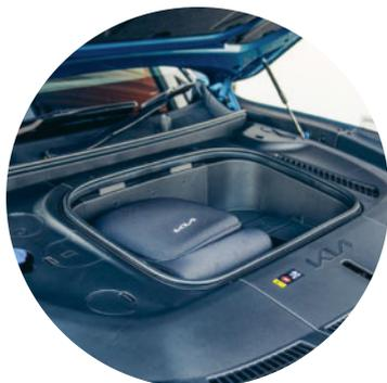
Un coffre à l'avant pour les câbles de recharge et autres accessoires.
