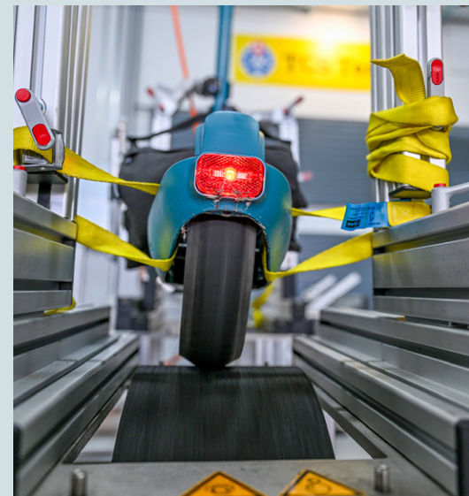
Festgezurrt auf dem TCS-Prüfstand zur Messung von Stromverbrauch und Reichweite.
