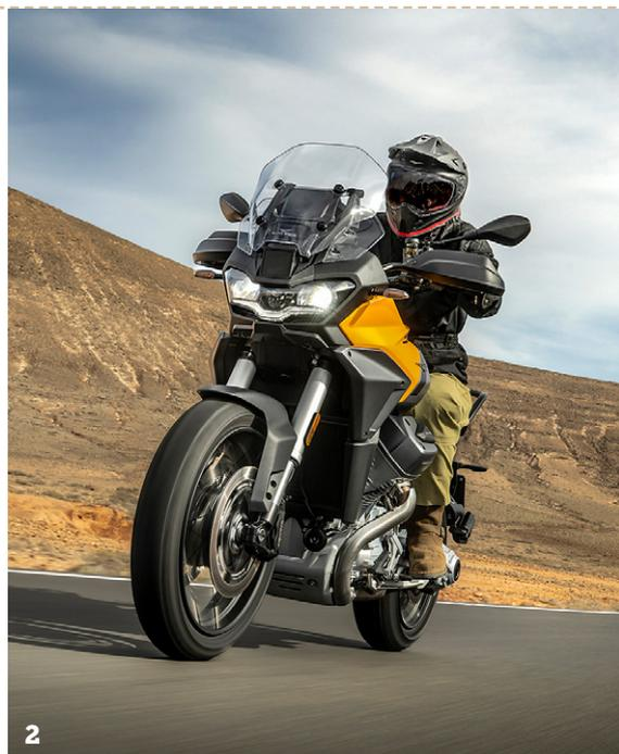
gitudinal typique de la marque. Le refroidissement par air des culasses, l'un des avantages de cette disposition, n'est plus indispensable avec le refroidissement liquide. Cela permet de se conformer aux normes antipollution et de générer la puissance que l'on attend d'une enduro haut de gamme. 84,6 kW (115 ch) et 105 Nm de couple garantissent de bonnes réserves de puissance, même en duo. Soit dit en passant, la passagère a fait l'éloge de la selle après une sortie à deux.
