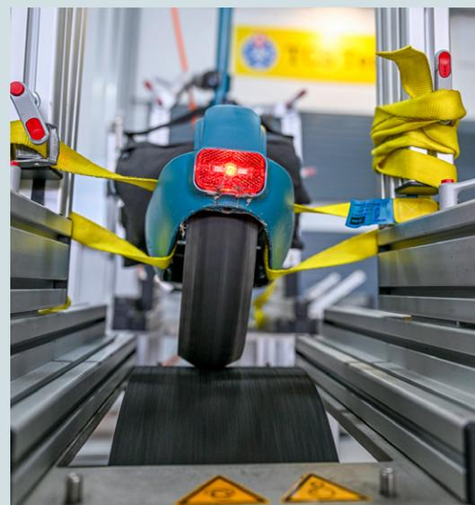
Une trott' sanglée sur le banc d'essai TCS pour mesurer la consommation électrique et l'autonomie.
